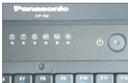
Neben dem Ein-/Ausswitcher sind sechs Kontroll-LEDs platziert
