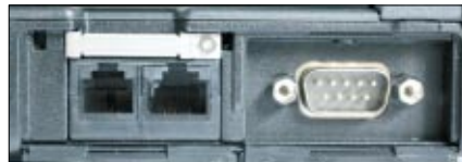
Neben der Modem- und der Netzwerkbuchse befindet sich mit der seriellen Schnittstelle eine echte Besonderheit
